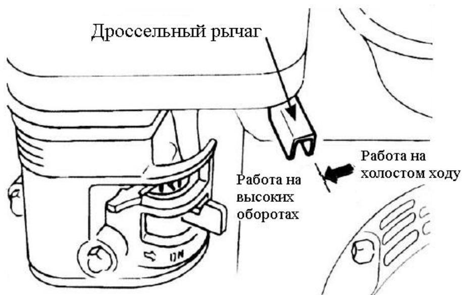
4. Установите выключатель двигателя в положение «Вкл.».
