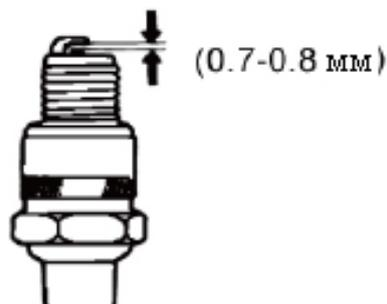
6. Установите свечу зажигания на место и закрутите ее с помощью свечного ключа.
