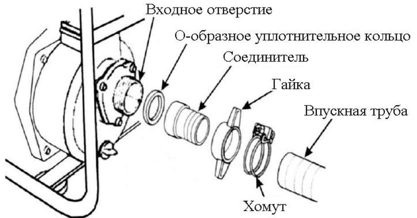
Установка впускного трубопровода
