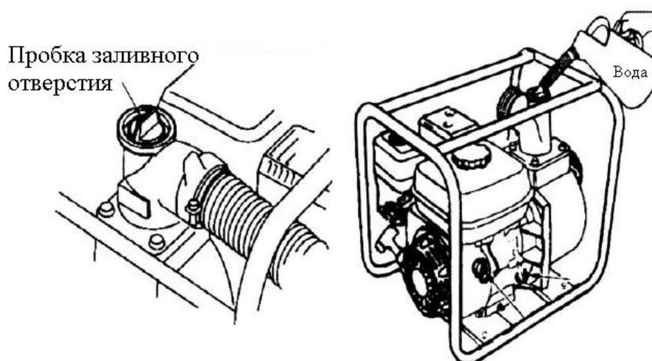
**Внимание!** Эксплуатация насоса без воды в рабочей камере может привести к перегреву насоса и повреждению уплотнений.
