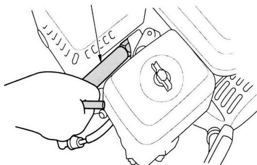
2. Проверьте свечу зажигания. При необходимости - удалите налет. Если изношены электроды или поврежден изолятор - замените.
