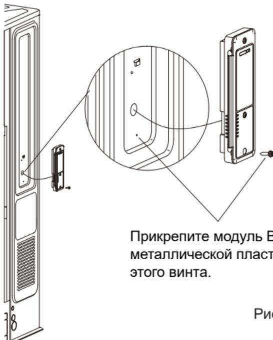
Прикрепите модуль Bluetooth к металлической пластине с помощью этого винта.
