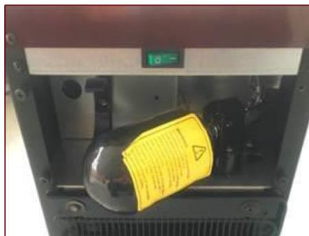
Установка картриджа CA06 на задней панели устройства.
