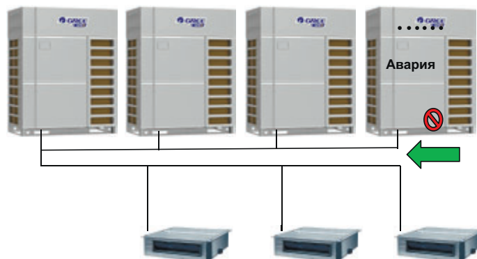
Извлечение хладагента из наружного блока
