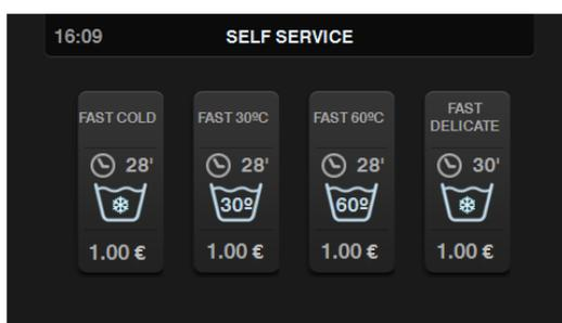
На дисплее находится от одной до шести кнопок (кнопки одинакового размера, расположены в центре окна). Число доступных кнопок зависит от числа программ, занесенных в список избранного. Например, если в избранном находится четыре программы, окно выглядит так, как показано на иллюстрации. Если в избранном хранится более шести программ, будут отображены только первые шесть.
