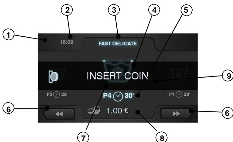
1. **Идентификация прибора.** Ярлык с присвоенным пользователем машине номером.
